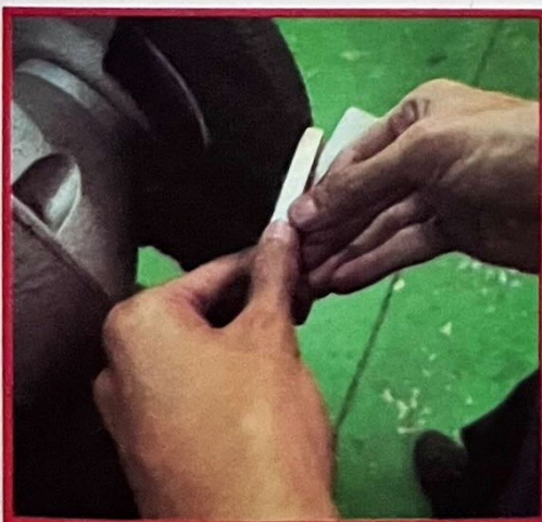
รูปที่ 9.24 ขั้นตอนที่ 1 แสดงการลับมุมคมตัด พร้อมทั้งลับมุมหลบข้าง
