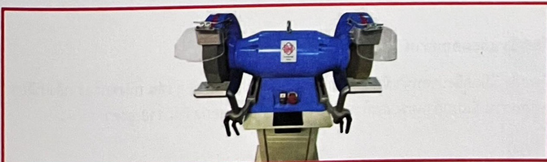
รูปที่ 9.37 ตรวจสอบความพร้อมของเครื่องเจียระไน กระจกนิรภัย การัดป้องกัน แท่นรองรับชิ้นงาน สวิตช์
