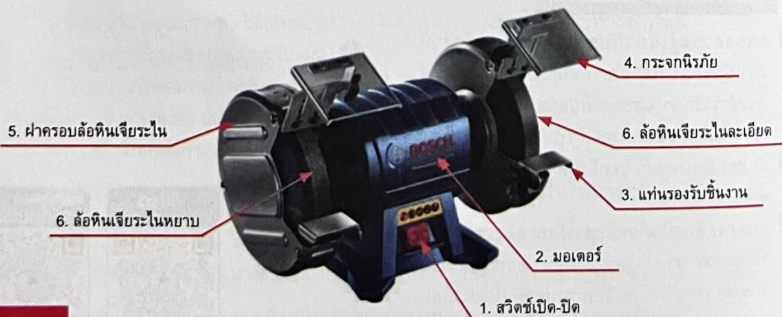
รูปที่ 9.3 ส่วนประกอบที่สำคัญของเครื่องเจียรโลหะแบบตั้งโต๊ะ
